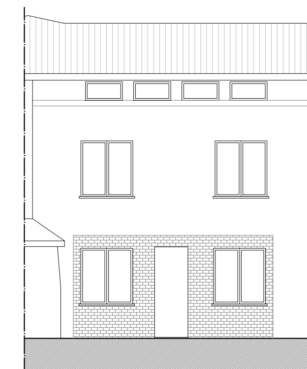
PROSPETTO RETRO - stato di fatto - scala 1:100
